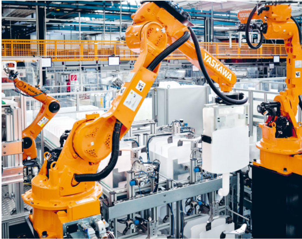
↑ Auf der neuen Produktionslinie in Pfullendorf werden Unterputzspülkästen zusammengebaut.
