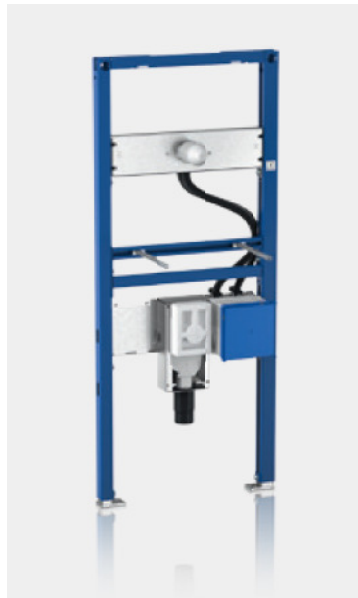
← Geberit Duofix Montageelement für Waschtische, vorbereitet für die Aufnahme einer Wandarmatur. Unten rechts befindet sich die Funktionsbox für Elektronik, Mischer und Energieversorgung und in der Mitte der anschlussbereite Unterputzsiphon. Die Integration der Armaturen in die Geberit Systemtechnik ermöglicht eine hohe Planungssicherheit für alle Beteiligten.
