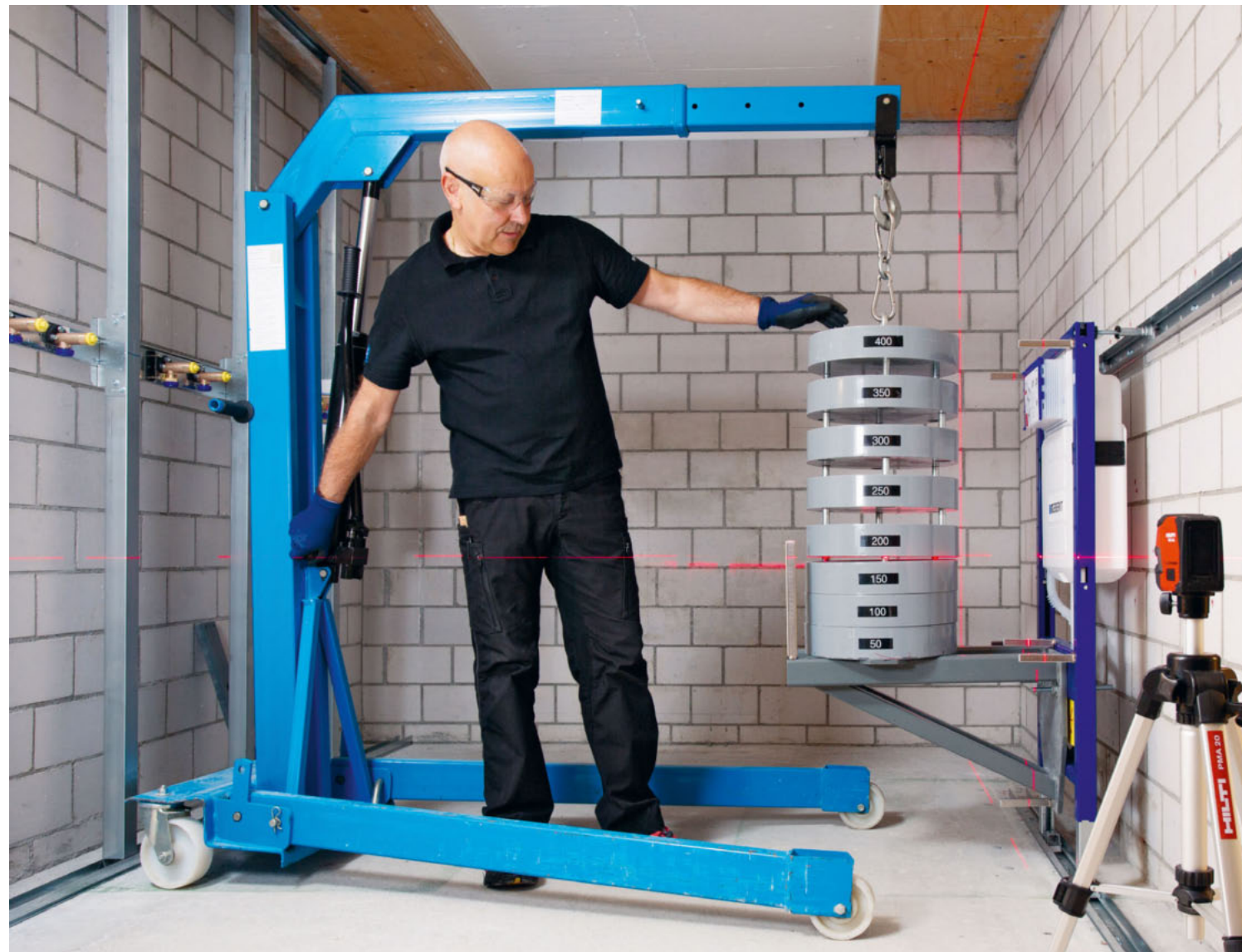
↑ Sorgfältig senkt René Gmür, Statikspezialist bei Geberit, die 50 kg schweren Gewichtsscheiben Stück um Stück auf den Spezialrahmen, der an einem Geberit Duofix Installationselement befestigt ist.
