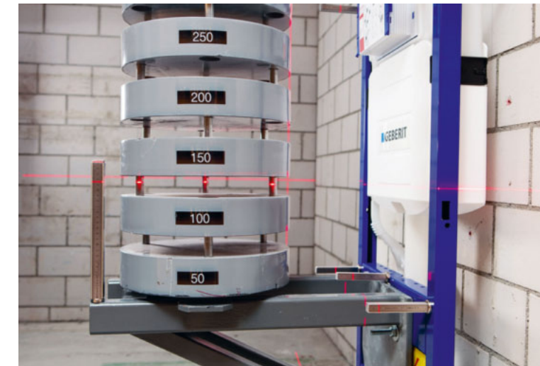
↑ Mittels Laserlicht werden die durch die Belastung entstehenden Verformungen gemessen.
