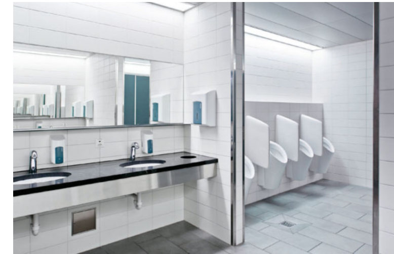
↑ Hygiene ist wichtig: Berührungsfreie Urinalspülungen und Waschtischarmaturen sowie automatische Schiebetüren gehören zum Standard.
